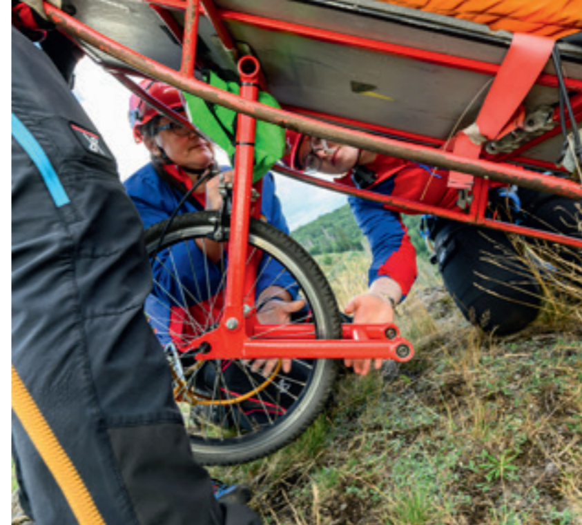
Oben angekommen, wird ein Rad unter der Trage befestigt.
